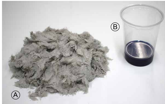
Die flüssige Härterkomponente Biresin® L90 (B) ist für eine sichere Mischkontrolle blau eingefärbt.
