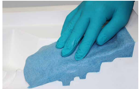
Biresin® L90 lässt sich sehr einfach in die auszufüllenden Konturen drücken. Die angenehme Geschmeidigkeit und homogene Konsistenz besteht während der gesamten Verarbeitungszeit.
